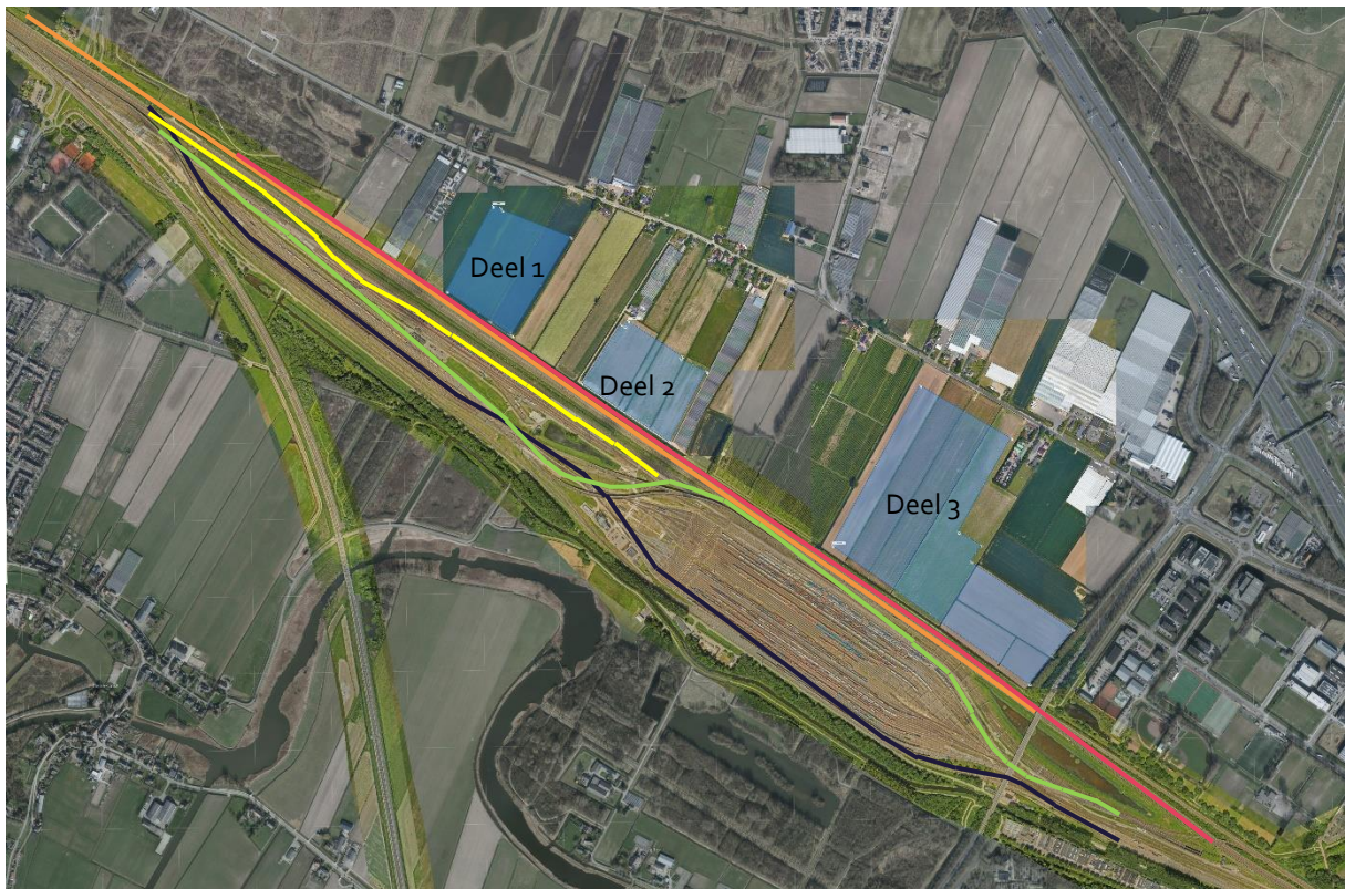
Figuur 4.1: Ingetekende zonnepark (transparant blauwe vlak) met daarbij de vijf routes waarvoor de reflectie berekend wordt.
