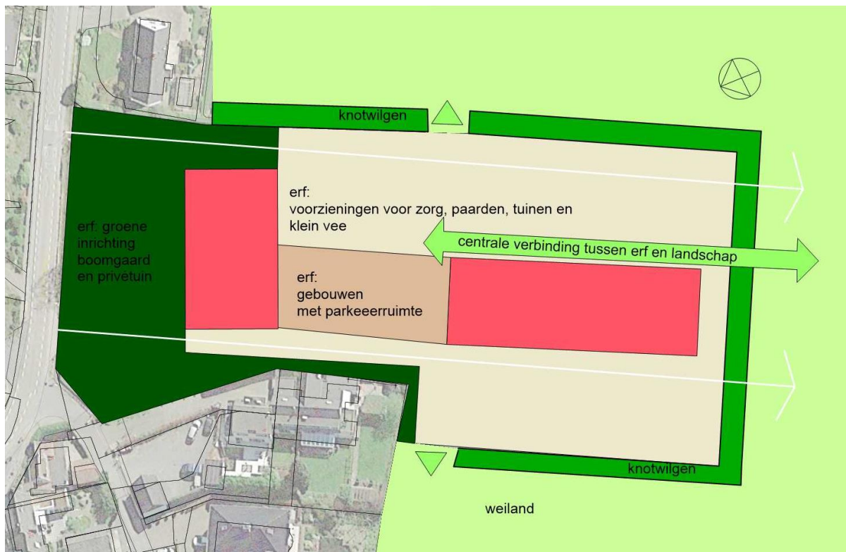
Afbeelding 6. Ruimtelijk en functioneel concept voor de erfinrichting. Zichtlijnen zijn met witte lijnen weergegeven.
