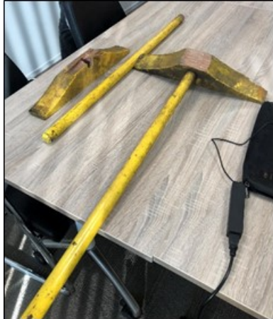
Figuur 2. De beide keggen die gebruikt zijn bij het wegzetten van de set spoorkranen
