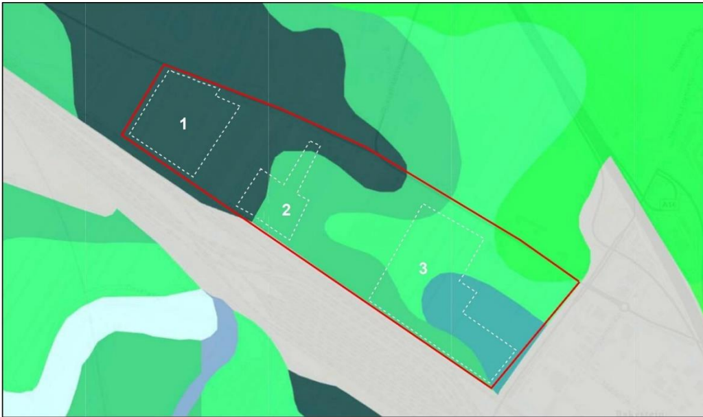
Afbeelding 10. Het plangebied (rood kader) en de drie onderzoekslocaties (witte, gestippelde kaders) op een uitsnede van de bodemkaart. Grijs= kalkarme drechtvaaggronden, donkergroen= kalkarme poldervaaggronden, licht- en grasgroen= kalkrijke poldervaaggronden, petrol= kalkrijke drechtvaaggronden (bronnen: Esri Nederland; https://www.arcgis.com/home/webmap/viewer/ )
